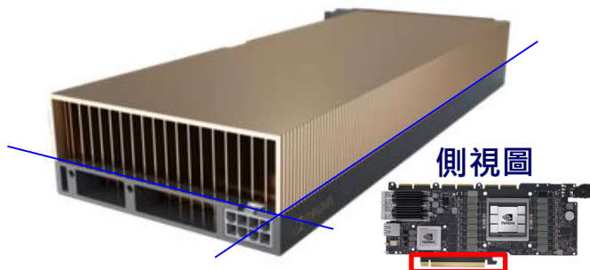
A100 PCIe版本之散熱模組(250W)
