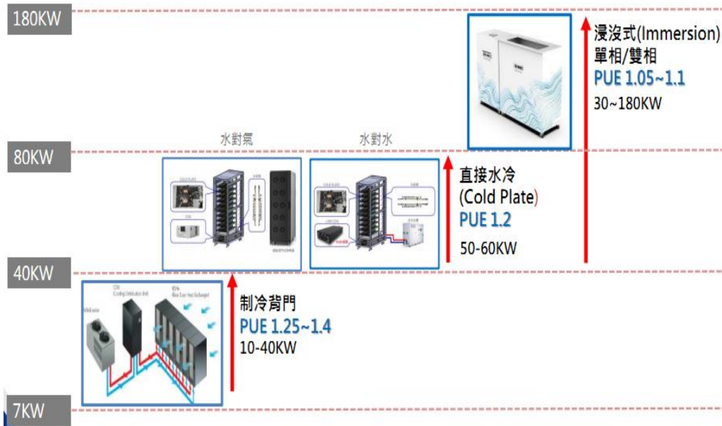
資料中心水冷系統類別
