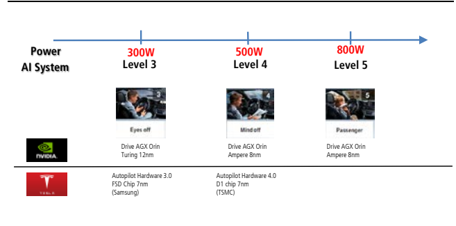
圖 14：水冷將應用於自動駕駛/Level 3 以後的 ADAS 系統
